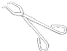
PINÇA METÁLICA: Usada para manipular objetos aquecidos.
