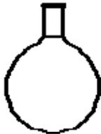
BALÃO DE FUNDO REDONDO: utilizado principalmente em sistemas de refluxo e evaporação a vácuo, acoplado a ROTAEVAPORADOR
